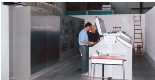
Frosttruhe zum Bestimmen der Frostbeständigkeit von Dachziegeln nach DIN 539-2 Freezing cabinet for determination of the frost resistance of clay roofing tiles according to German Standard DIN 539-2
