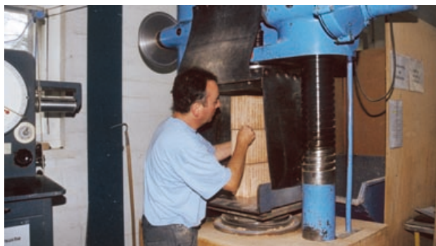
Bestimmung der Druckfestigkeit an Mauerziegeln Determination of the compressive strength on masonry bricks
