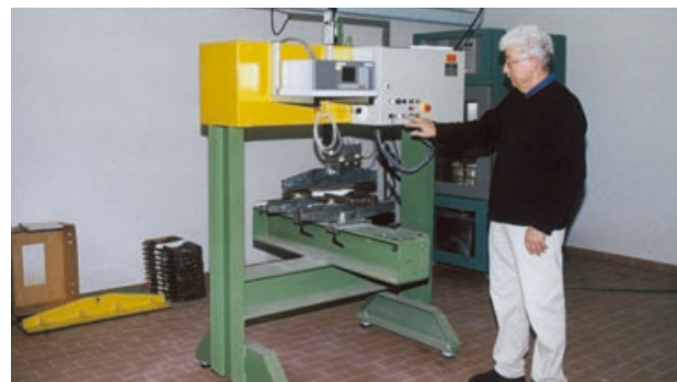
Gerät zum Bestimmen der Tragfähigkeit von Dachziegeln Equipment for the determination of the loadbearing capacity of clay roofing tiles
